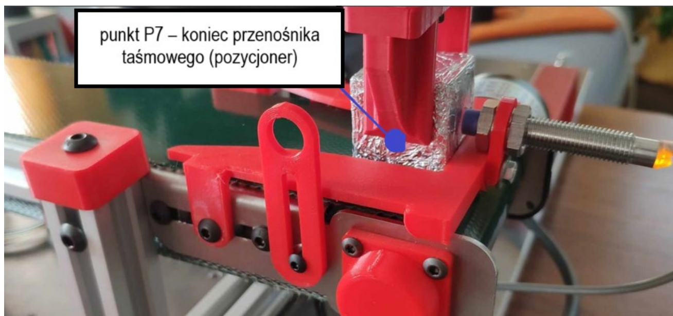
Rysunek 3 – widok punktów pobierania i odkładania na przenośniku taśmowym
